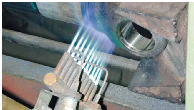
Рис 8. LINDOFLAMM® предварительный подогрев карданного вала с электрическим поджигом
