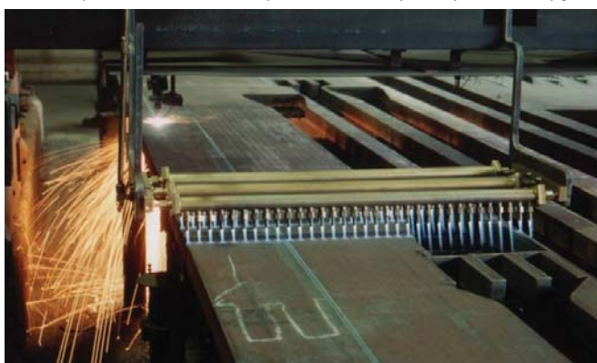
Рис 2. Зоны предварительного подогрева
