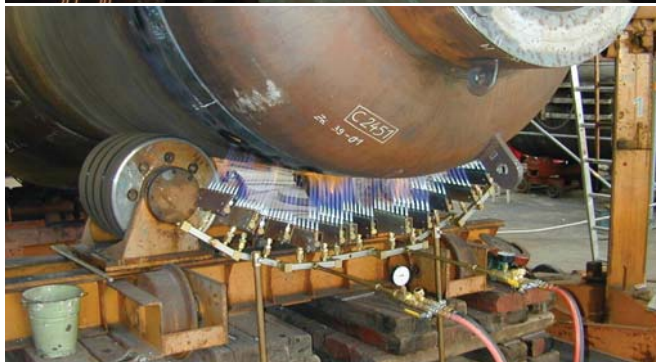
Рис 1. Подогрев при резке и сварке специальных сталей
