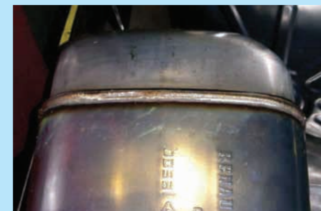
Г. Сварной шов в смеси CRONIGON® нержавеющей стали аустенитного класса
