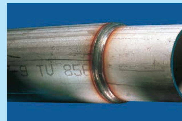
Б. Сварной шов в смеси CRONIGON® нержавеющей стали аустенитного класса
