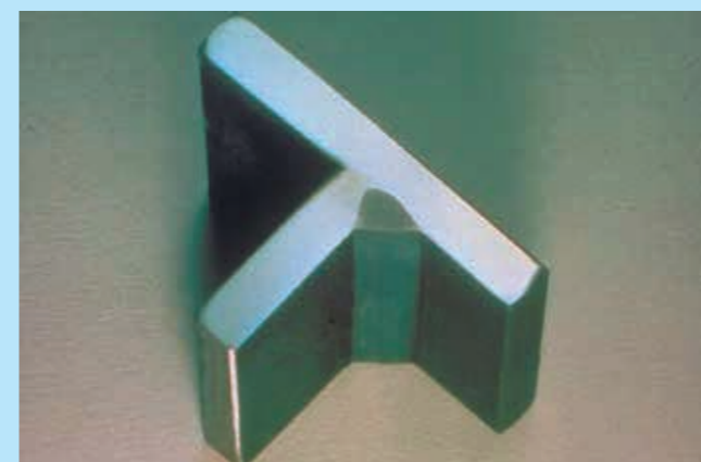
А. Профиль шва в смеси CORGON® 10
